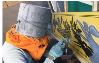
Gambar13. Proses *Sandblasting* (Proses Pengukiran)
